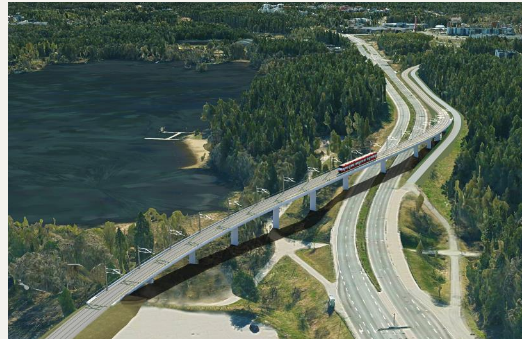
Kuva: Havainnekuva valtatie 12 ylittävästä raitiotiesillasta Alasjärven lounaispuolella.
